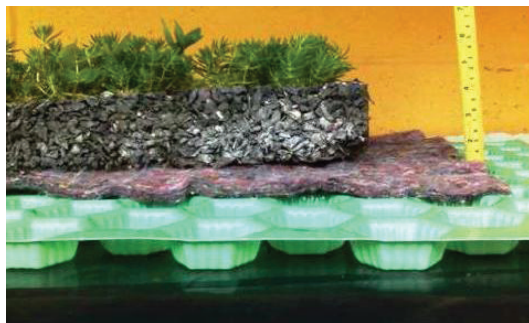
Figura 07 – Sistema Alveolar Fonte: www.ecotelhado.com.br
