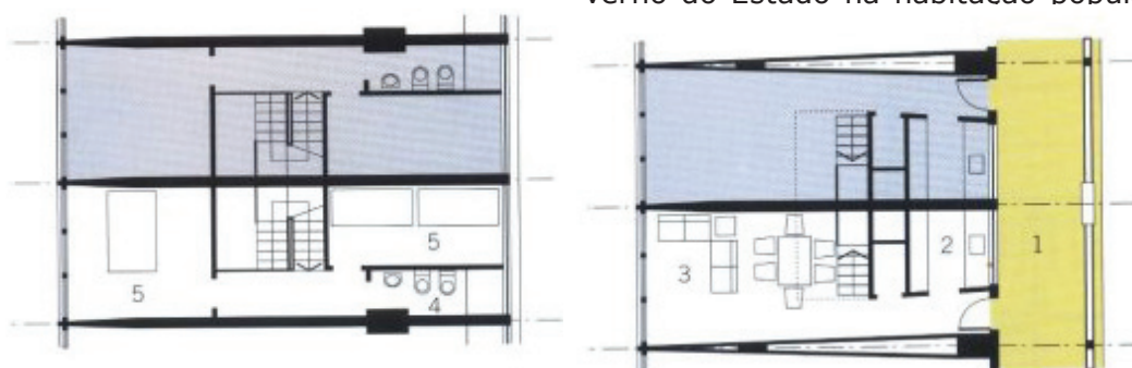
Figura 1 planta conjunto Pedregulho - RJ – apartamento duplex com dois dormitórios (pavimento superior e inferior) projetado por Affonso Eduardo Reidy em 1947.
