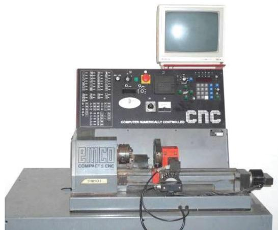
Figura 2: Torno Compact 5 CNC da EMCO.
