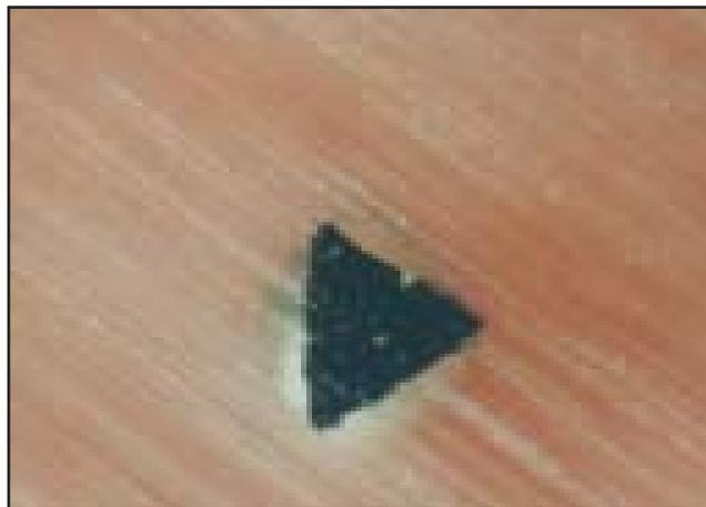
Figura 9 - Corte transversal da lima Flexofile.
