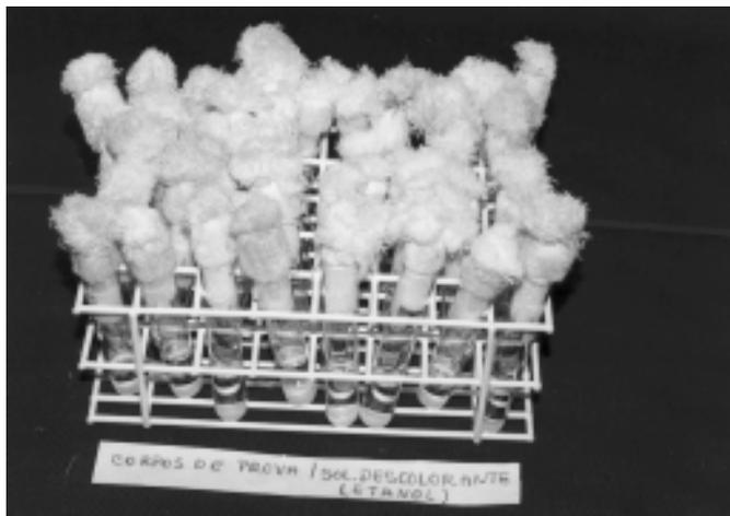
Figura 04 - Tubos de ensaio com etanol e corpos de provas
