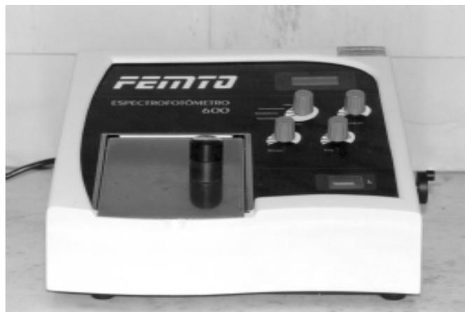
Figura 06 - Aparelho de Espectrofotometria 600 FEMTO, utilizado na avaliação de mancharamento
