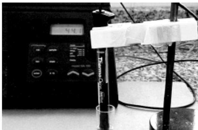
Figura 3. - Eletrodo Específico de Flúor
